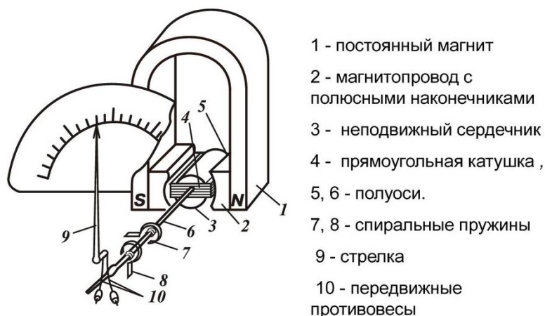
Рисунок 2 - Строение магнитоэлектрического механизма
