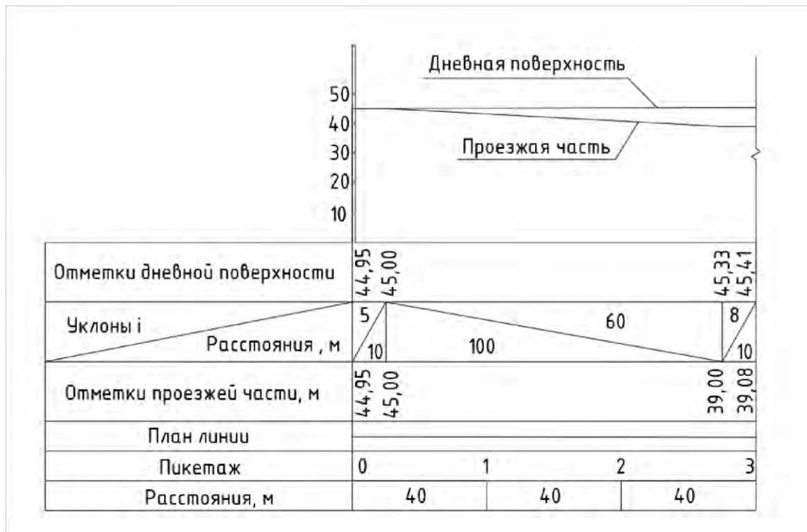
Рисунок 4 – Продольный профиль трассы тоннеля в точка А.
