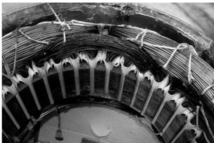
Рисунок 3 Неисправность обмотки статора
