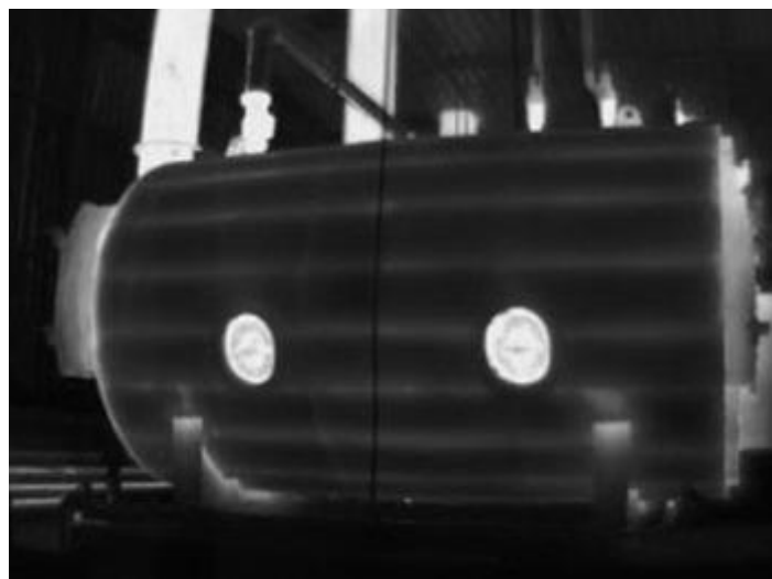
Рисунок 6 Тепловизионная картина нагрева электродвигателя
