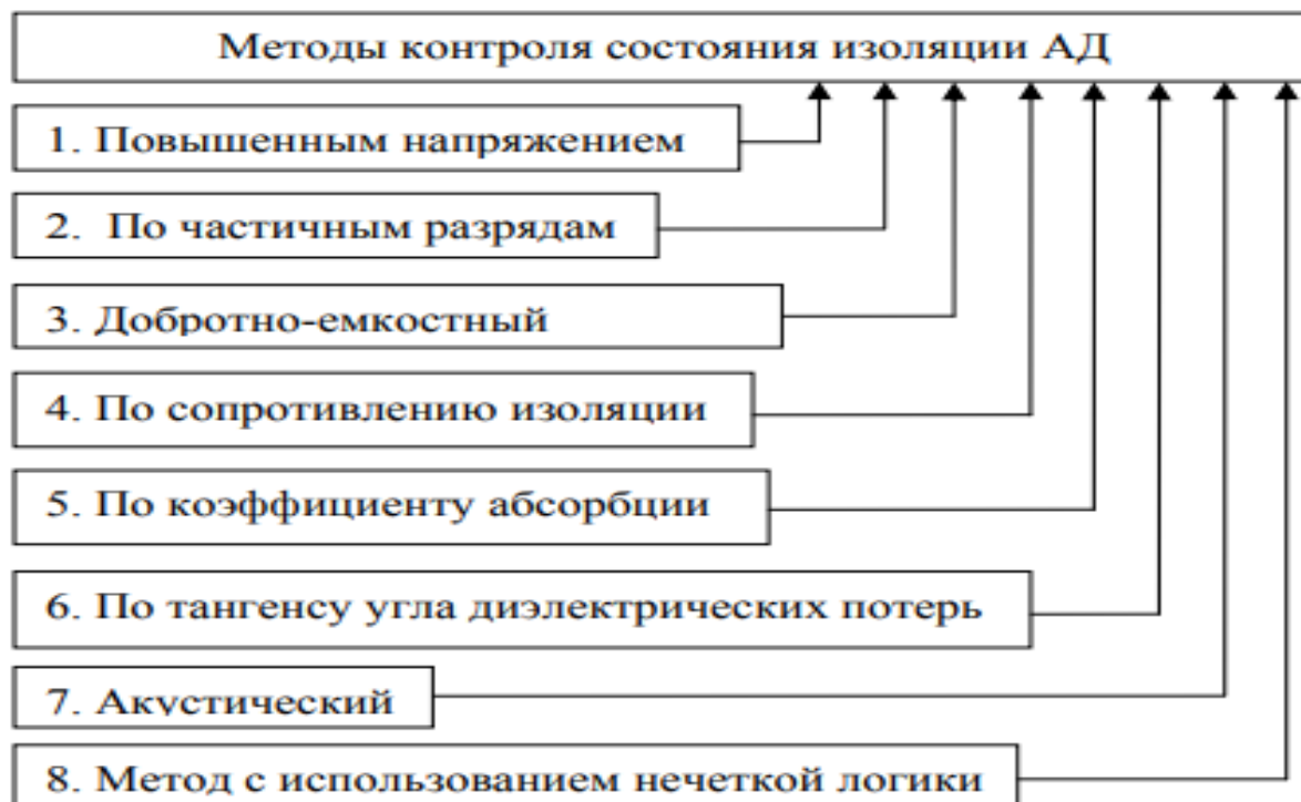
Рисунок 1. Методы контроля состояния изоляции АД
