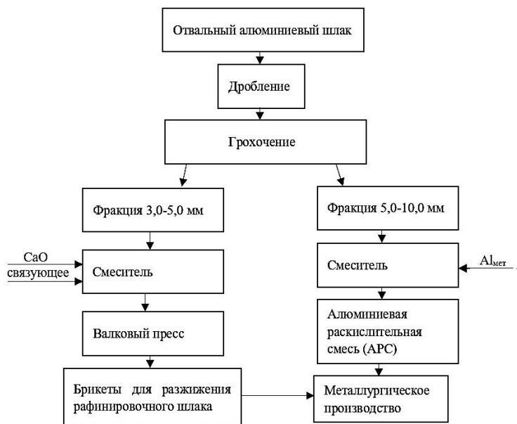
Рисунок 1 – Схема подготовки отвального алюминиевого шлака при получении материалов для внепечной обработки стали
