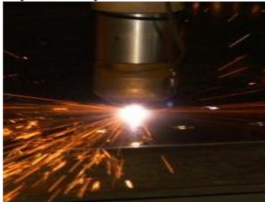
Рисунок 3 Плазменная резка
