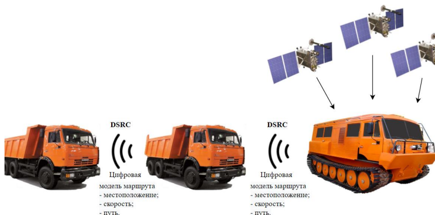
Рисунок 2 – Схема обмена информацией транспортных средств в колонне.
