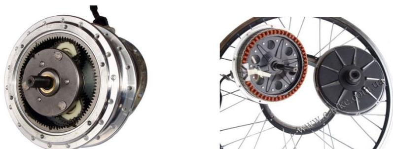
Мотор-колесо имеет следующий принцип действия: в неподвижном статоре создается вращающееся магнитное поле, которое, взаимодействуя с постоянными магнитами ротора, заставляет его крутиться. Статор изготовлен из пластин электротехнической стали, и похож на многолучевую звезду, на лучах которой намотаны обмотки. Когда в этих обмотках протекает электрический ток, лучи становятся магнитами (электромагнитами), и притягивают к себе постоянные магниты, расположенные на роторе.
