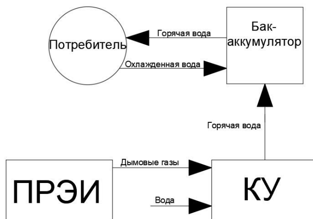
Рисунок 2 – Передача горячей воды на дальнейшее расстояние
