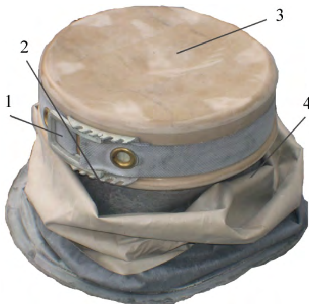
Рис. 47. Горловина резервуара РДВ-1500: 1 – ремень; 2 – горловина; 3 – крышка; 4 – чехол
