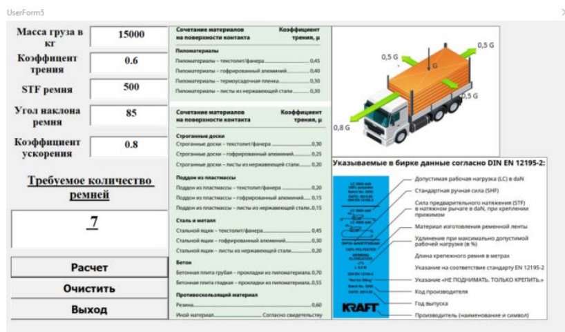
Рисунок 2 – Интерфейс приложения для определения количества прижимных ремней Источник: собственная разработка авторов
