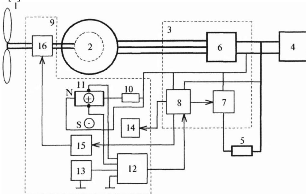
1 – ветродвигатель; 2 – генератор; 3 - блок управления; 4 – аккумуляторная батарея;
