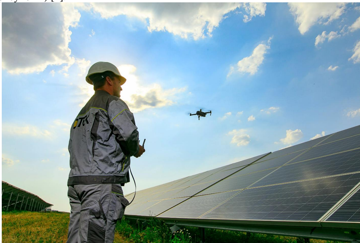
Рисунок 1 – Использование БПЛА для проверки фотоэлектрических панелей [2]
