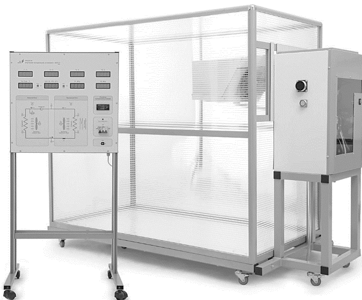
Рисунок 1 – Холодильная установка НТЦ-23.63
