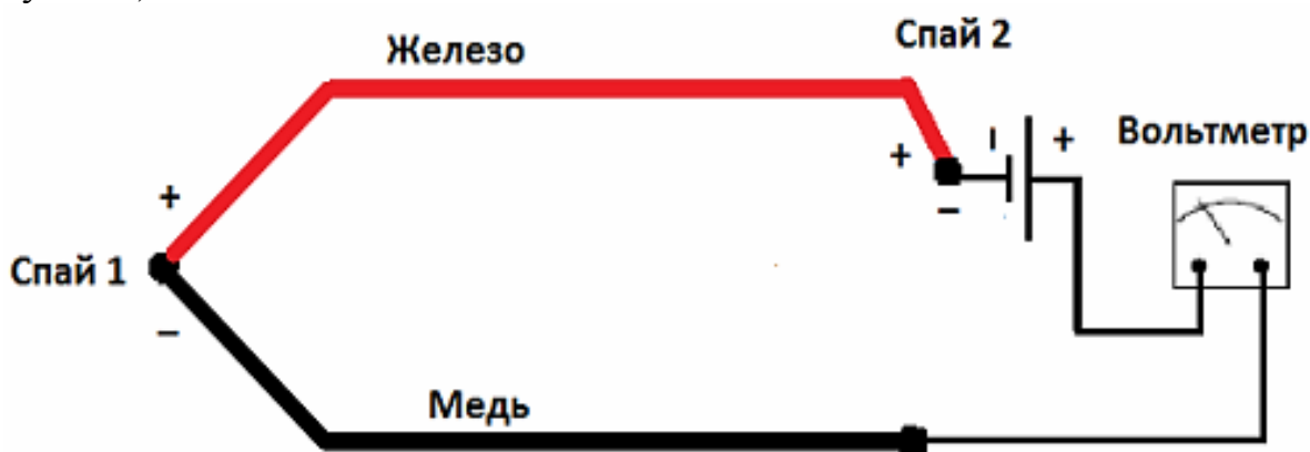
Рисунок 2 – Термоизмерительный контур, в котором влияние «холодного спая» скомпенсировано.
