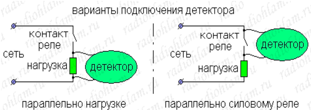
Рисунок 3 – варианты подключения детектора
