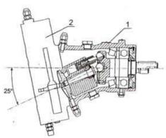
Недостаток устройства - возможный угол поворота распределителя с блоком цилиндров по отношению к оси вала ограничен, так как каналы в корпусе во всех положениях поворота распределителя должны уплотняться распределителем.
