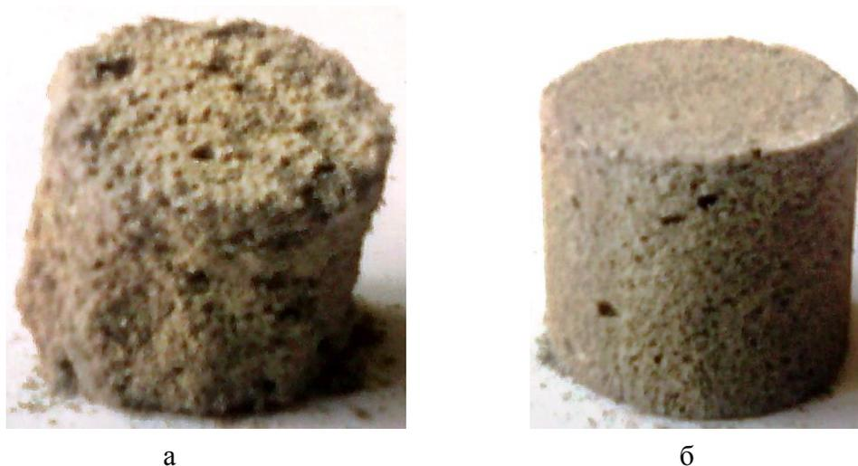
**Рис. 3. Образцы пенобетона на основе глиноземистого цемента, шамота и глины в отсутствие (а) и с добавкой 6% цитрата натрия (б) от массы цемента  $V/T=0,6$**
