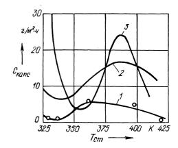
где  $\Delta G_{\rm Zn}$  — убыль массы цинкового датчика за время эксперимента, г; S — поверхность цинкового датчика, м $^2$ ;  $\tau$  — время эксперимента, ч; K — коэффициент пропорциональности, определяемый по аналогии с сернокислотной коррозией из следующих соображений: считаем, что убыль массы цинкового колпачка объясняется коррозионным воздействием на него соляной кислоты HCl:
