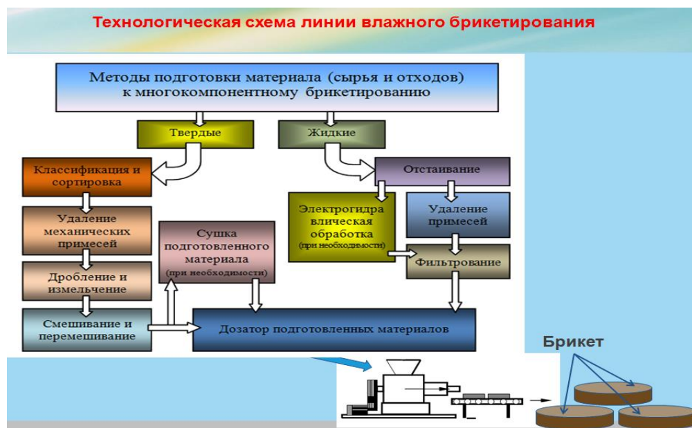
Рис. 1. Технологическая схема подготовки и брикетирования MSF топлива Fig. 1. Technological scheme of preparation and briquetting of MSF fuel
