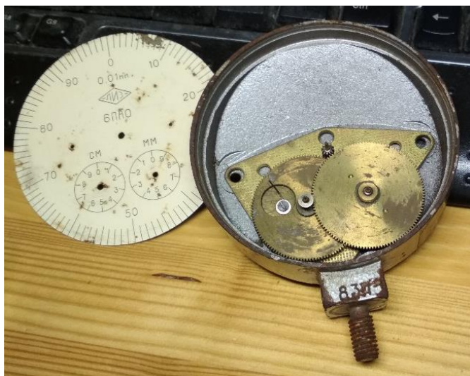
Рисунок 10 – Внутренне устройство прогибомера Аистова
