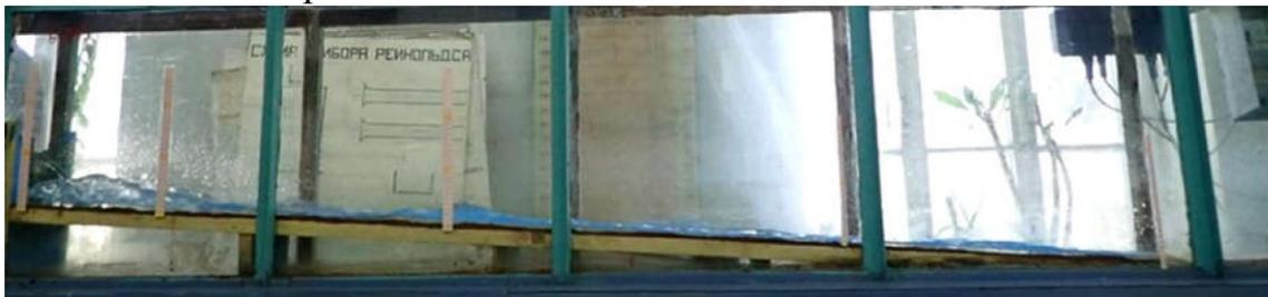
Рисунок 2 – Общий вид волны перемещения при мгновенном открытии затвора
