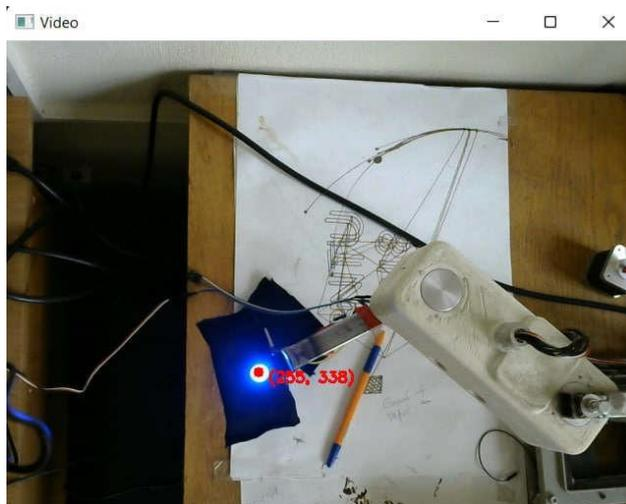
Рисунок 1 – Отображение координат центра LED излучателя
