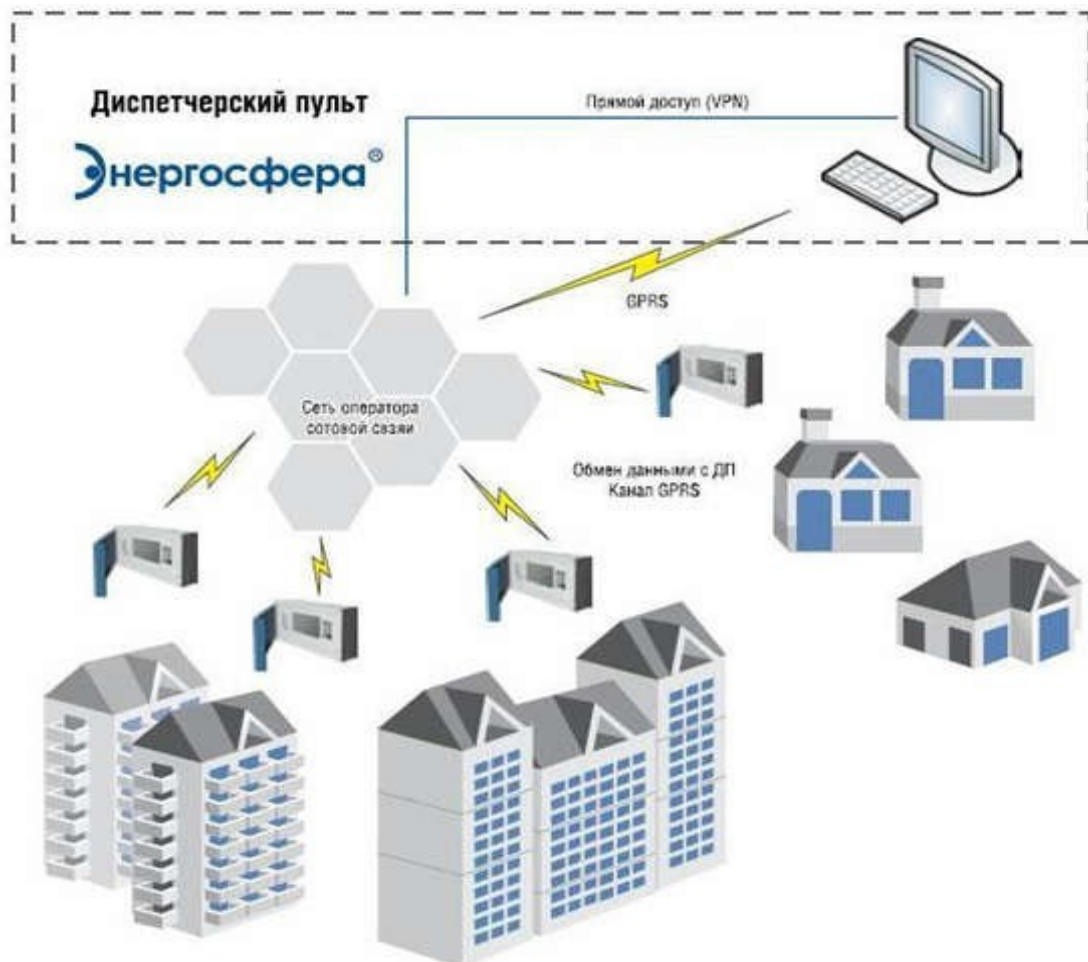
Рисунок 1 – Пример двухуровневой АСКУЭ компании «Энергосфера»
