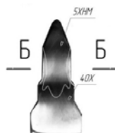
Рис 2- Фотография продольных шлифов образцов, полученных по технологии СГВ и использованных для измерения твердости и микроструктурного анализа в зоне соединения разнородных материалов
