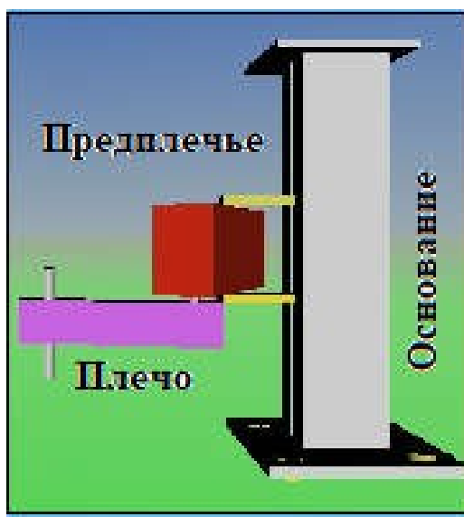
Рис.1. Конструктивная схема 3D принтера на основе модели Scara
