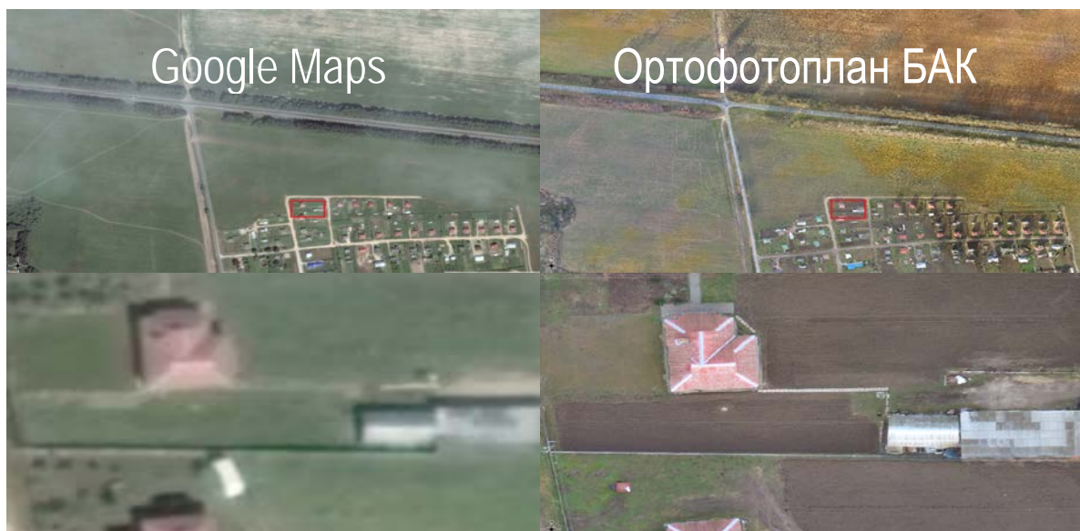
Рис.1 – Ортофотопланы полученные по результатам космосъемки и аэрофотосъемки с использованием БАК
