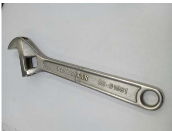
Рисунок 1 – Результат электрохимического полирования изделия из конструкционной легированной стали 40ХФА электролите на основе органического растворителя
