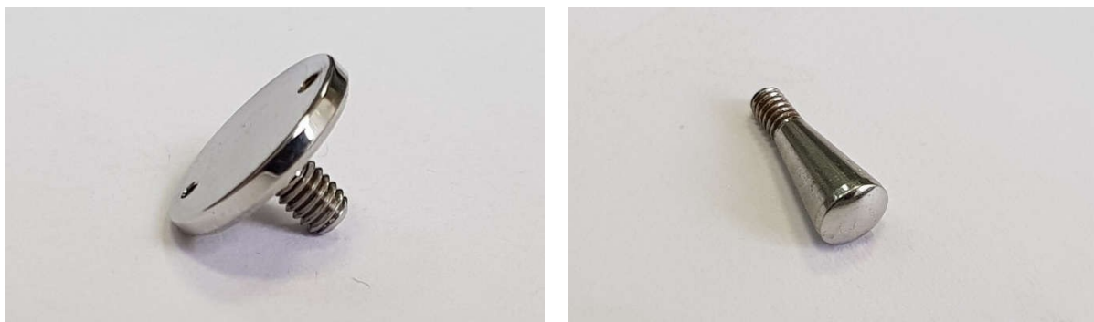
Рис. 3 – Образцы изделий из коррозионностойкой стали после полирования с применением управляемых импульсных режимов электролитно-плазменной обработки
