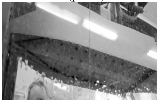
Рис. 2. Конструкция со скегами (блочно-пакетная подача воздуха)
