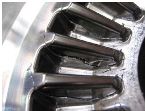
Рисунок 3 – Вид разрушения формообразующих зубьев матрицы
