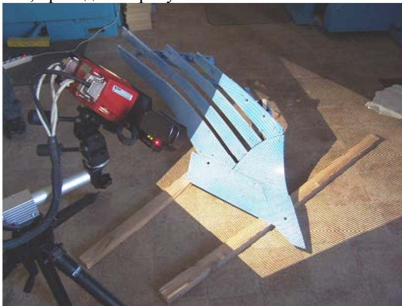
Рис. 1 – Оцифровка плуга фирмы «Lemken» бесконтактной оптической системой оцифровки и измерений ATOS II
