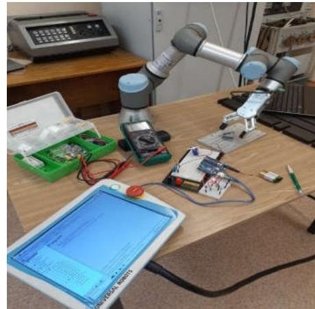
Рисунок 1 – Учебный робототехнический комплекс на базе ПР UR3
