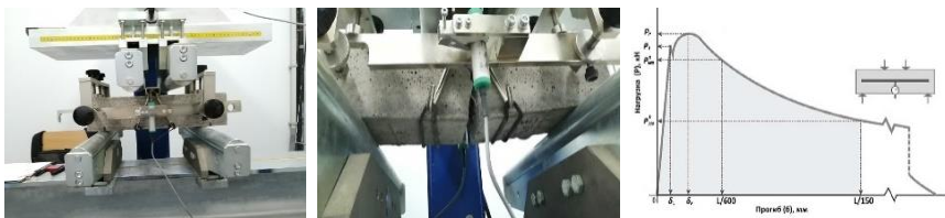
Рисунок 5 – Испытание образцов-призм с надрезом
