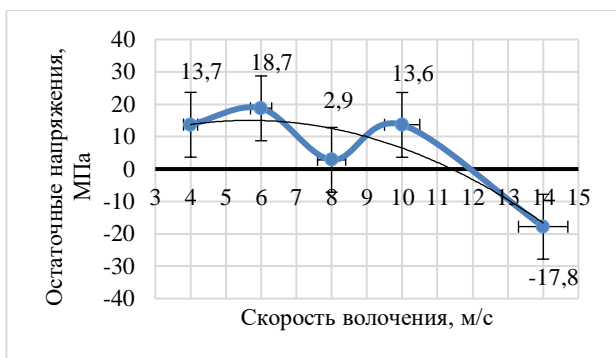
Рисунок 5 – График зависимости изменения величины остаточных напряжений в проволоке от скорости волочения (результатирующий)
