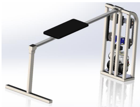
Рис. 1. Пневматический тренажер для совершенствования гребковых движений
