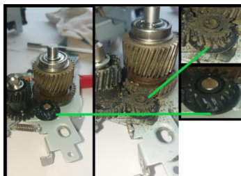
Рис. 2. Узел вращения передаточной ленты в печи для запекания тонера
