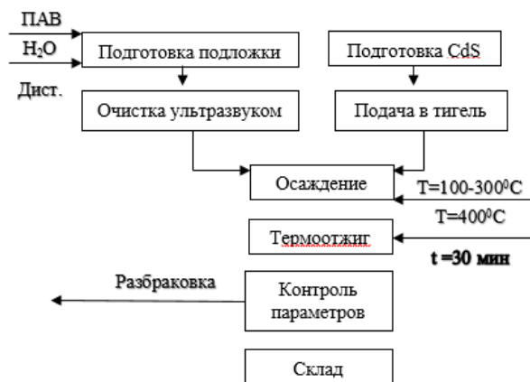
Рис. 1. Технологическая схема получения полупроводниковых пленок CdS и CdTe
