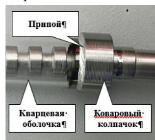
Рис. 2. Разработанный токоввод в газоразрядную лампу
