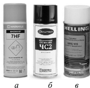
Рис. 1. Рассматриваемые магнитные суспензии: Magnaflux 7HF (а); Элитест ЧС2 (б); Helling NRS 103 (в)
