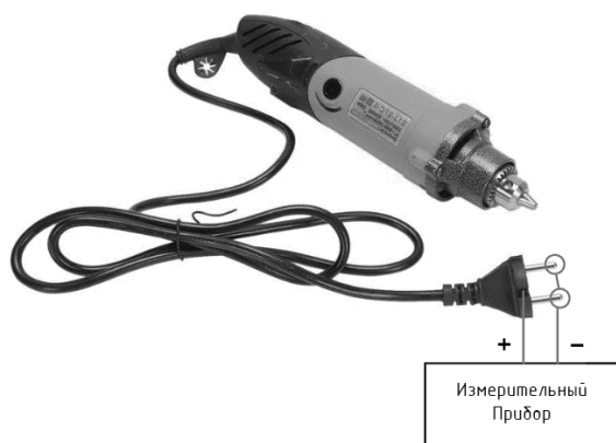
Рис. 1. Измерение изоляции на электроинструменте
