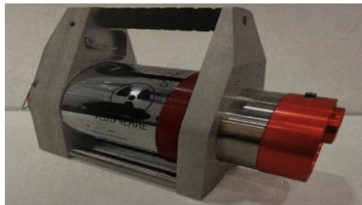
Рис. 1. Внешний вид гамма-дефектоскопа Exertus Dual 120
