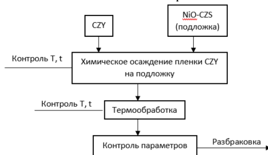
Рис. 1. Схема синтеза пленочного электролита
