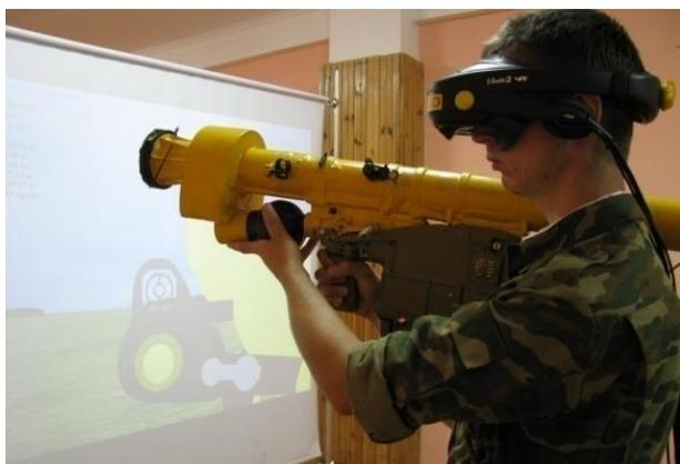
Рисунок 3 – Унифицированный электронный тренажер ПЗРК «Игла» 9Ф2003
