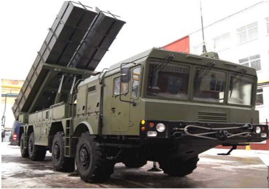
Рисунок 9 – «Полонез» на шасси МЗКТ-7930
