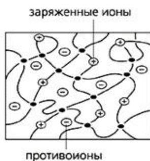
Рис. 1. Схематическое изображение полиэлектrolитного геля
