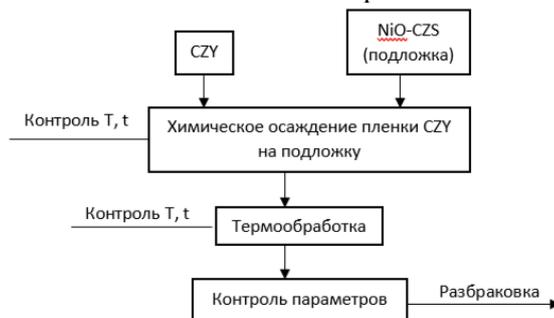
Рис. 1. Схема синтеза пленочного электролита
