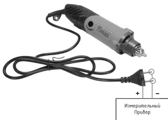
Рис. 1. Измерение изоляции на электроинструменте
