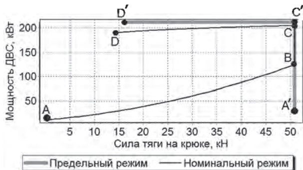
Рисунок 6 — График потребляемой мощности ДВС трактора для u_{TP} = 64,85 с учетом ограничений M_p по \delta_{доп} (участки BC и A'C') для номинального и предельного режимов и по s_n (участки AB и CD) для номинального режима при значении P_{max} = 220 кВт
