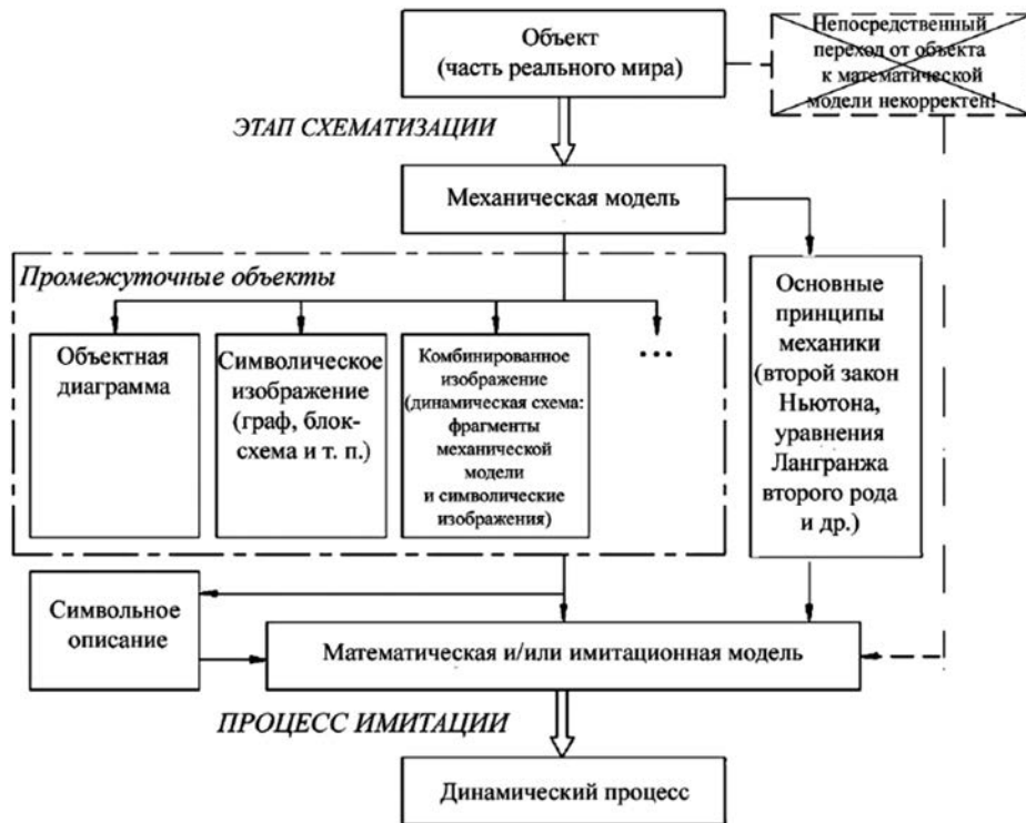
Рисунок 4 — Основные процедуры схематизации объекта механики [19, 20]
