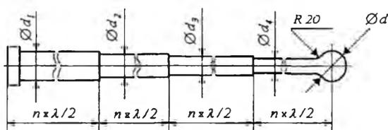
Коэффициент усиления ступенчатых волноводов равен:  $K = \frac{R_1^2}{R_o^2}$ , где  $R_1$  и  $R_o$  - радиусы широкого (входного) и узкого (выходного) торцов ступени волновода соответственно.
