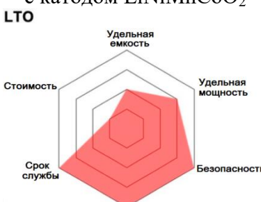
LTO / Литий-титанат-оксидные с анодом Li 4 Ti 5 O 12
