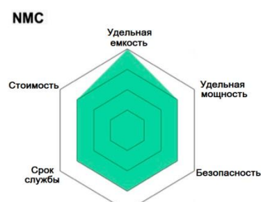
NMC / Литий-никель-марганец-кобальт-оксидные с катодом LiNiMnCoO 2
