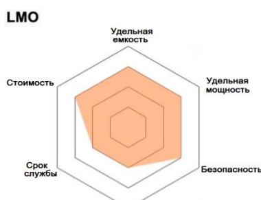
LMO / Литий-марганцево-оксидные с катодами LiMn 2 O 4 и Li 2 MnO 3
