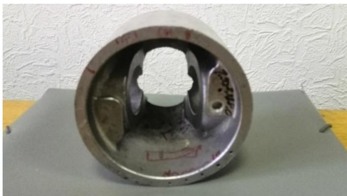
Рисунок 2.1 – Первая и третья серии сверлений различных диаметров
