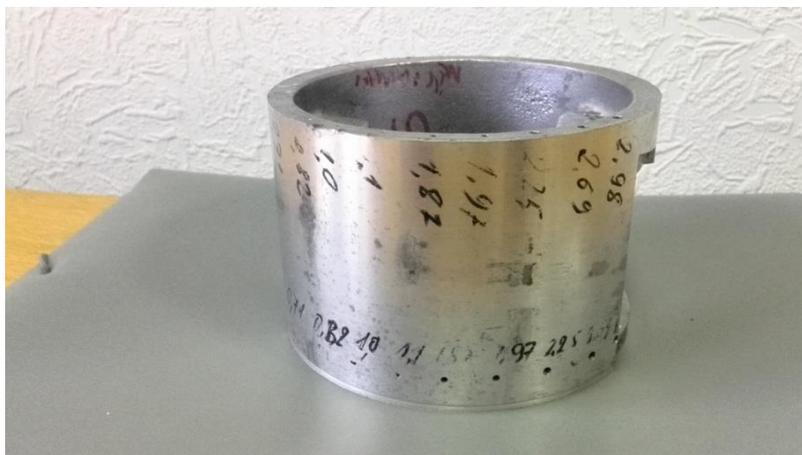
Рисунок 2.2 – Вторая серия сверлений различных диаметров
