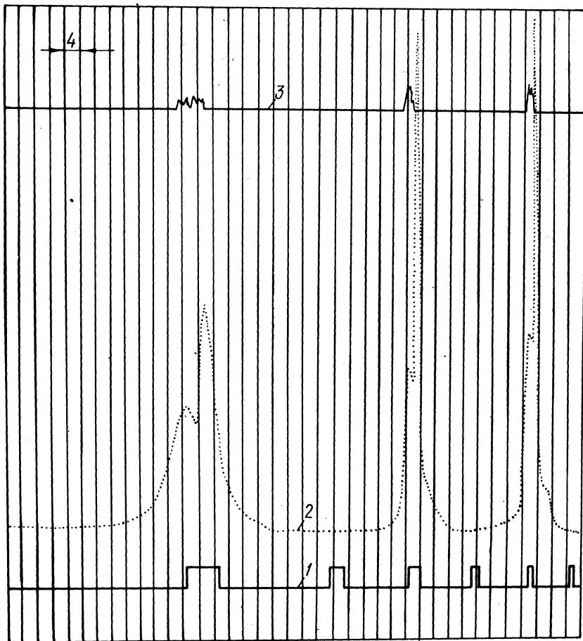
Рис. 1. Осциллограмма первых вспышек в цилиндре при запуске двигателя Д-50 ( n = 160 об/мин., температура окружающей среды +15^{\circ}\text{C} ):
