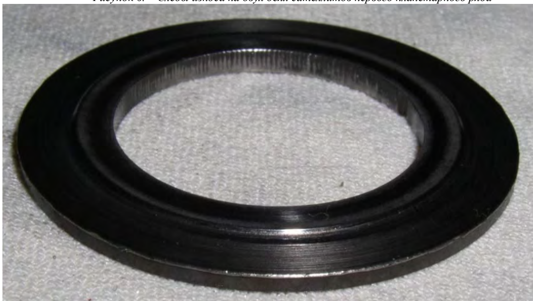
Рисунок 7. – Износ одной из четырех шайб сателлитов третьего планетарного ряда
