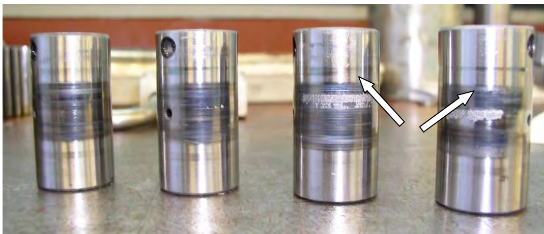
Рисунок 6. – Следы износа на двух осях сателлитов первого планетарного ряда
