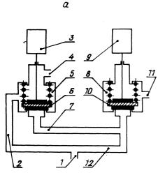
Рис. 2. Трехфазовый модулятор фирмы "DBA":
