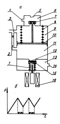
Рис. 1. Поршневой двухфазовый модулятор фирмы "The Bendik ":
