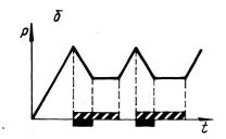
мает исходное положение, отсекая полость 11 от тормозного крана. Сжатый воздух из полости 11 через каналы 2 и 3 выпускается в атмосферу, поршень 10 под действием пружины 8 возвращается в исходное положение. Тормозной исполнительный механизм через канал 4, полость 6 и канал 5 соединяется с тормозным краном. В дальнейшем процесс повторяется.
