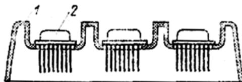
Рис. 8.1. Полиэтиленовый вкладыш с загруженной микросхемой:
