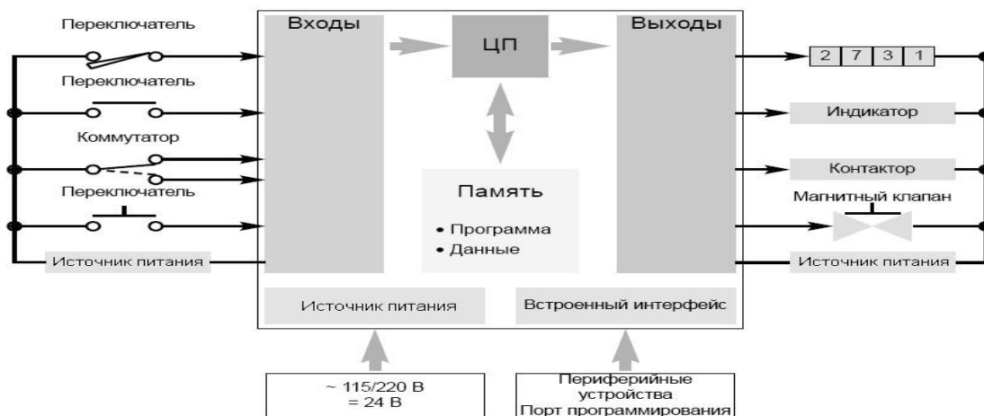
Рисунок 2 – Функциональная схема СУ на базе ПЛК
