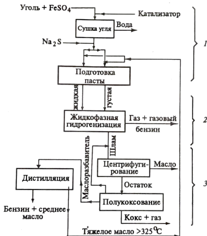
Рисунок 1 – Схема жидкофазной гидрогенизации угля 1 – приготовление топливно-масляной пасты; 2 – гидрогенизация пасты; 3 – переработка продуктов процесса [1]
