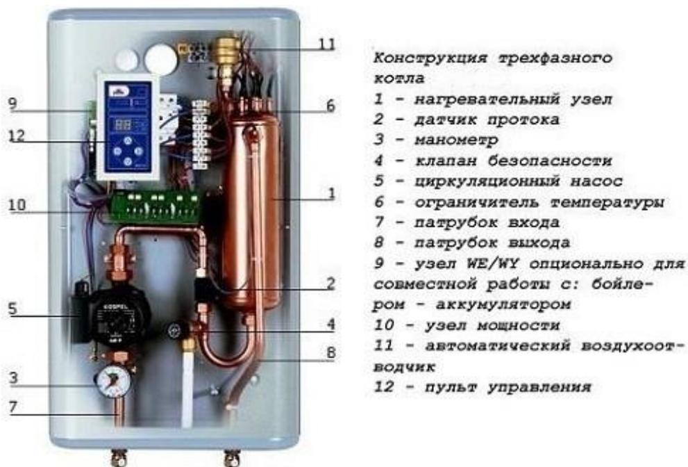
Рисунок 2 – Конструкция трехфазного электродного котла [1]
