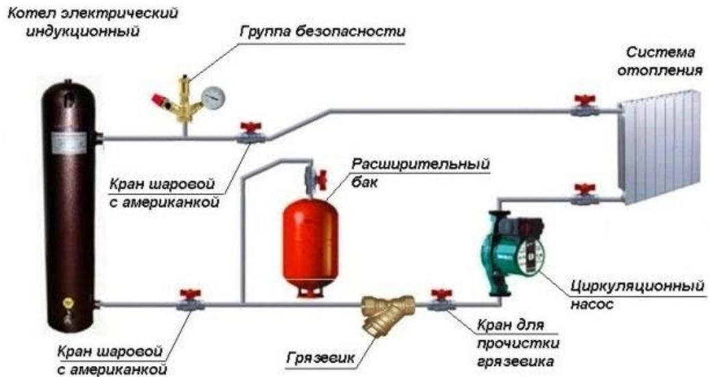
Рисунок 3 – Схема установки электродкотла для домашнего отопления [2]
