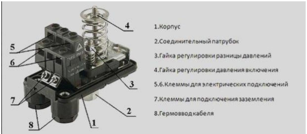
Рисунок 4. – Устройство типового датчика
