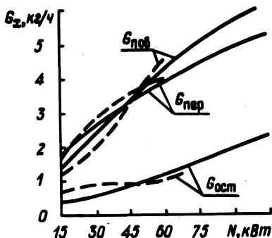
Рис. 1. Эмпирические и функциональные кривые зависимостей расхода топлива на холостом ходу и остановках от мощности двигателя при сплошной культивации.
