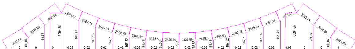
Рисунок 6 – Эпюра усилий N от расчетной нагрузки (кН)
