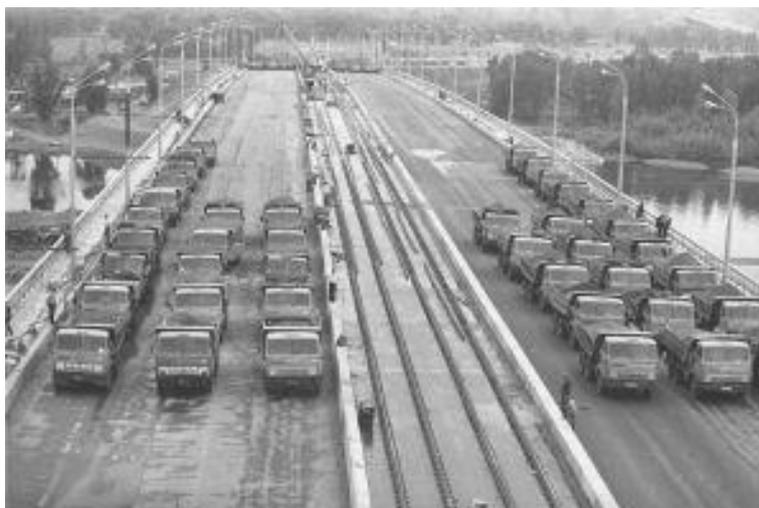
Рисунок 2 – Испытание моста
